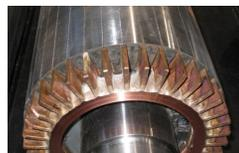
Figura: Rotor con barras de cobre
