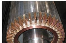
Figura: Rotores con barra de cobre
